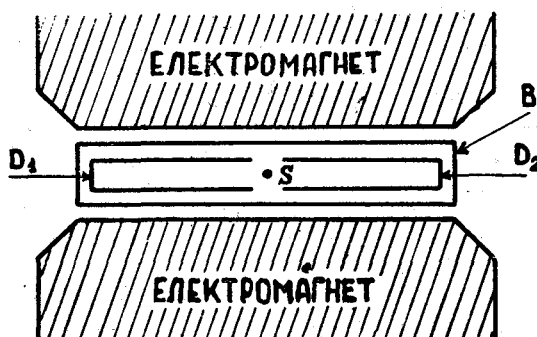
Сл. 2. Положбата на електродите меѓу половите на електромагнетот кај циклотронот.
